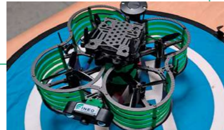
Drone d'inspection ©IneoNucléaire
