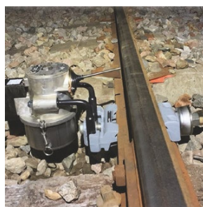
De gauche à droite : Contrôleur d'aiguille connecté, Compteur d'essieux connecté, Détecteur de position connecté pour leviers
